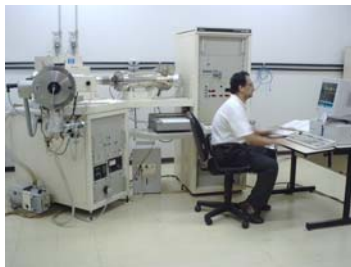
Espectrômetro de massa Finnigan MAT 262 - Laboratório de Geologia Isotópica (Pará- Iso).
